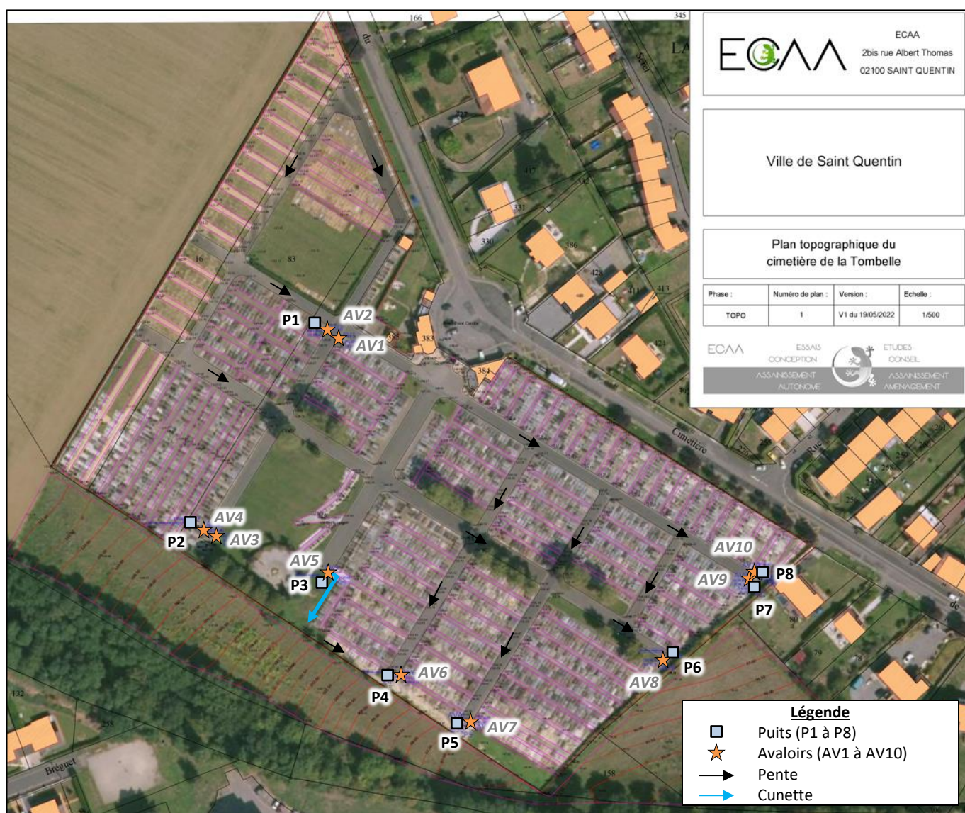
Figure 5 : Ouvrage de gestion des eaux pluviales du cimetière de la Tombelle (source : ECAA ; ECR ENVIRONNEMENT)
